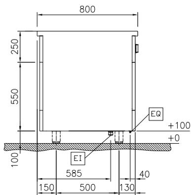
EI = Conexión eléctrica (energía)
